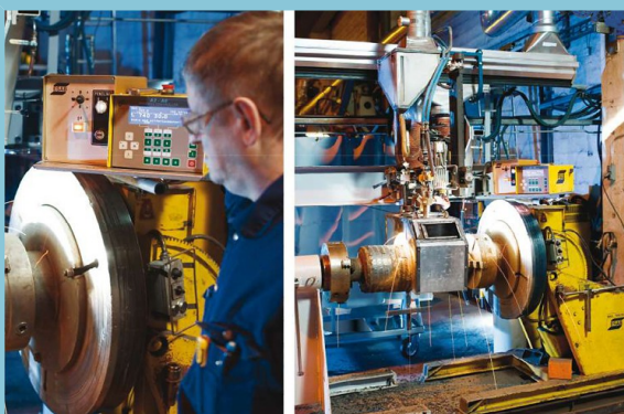
Bij bovenstaande retrofit van een geautomatiseerd lasproces werden nieuwe laskoppen geïnstalleerd en de bestaande stroombron geüpgraded, met het oog op een stabiel proces
